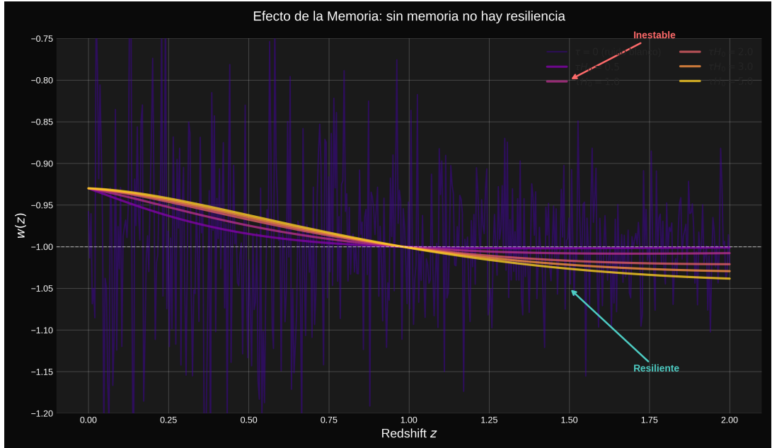
Figura 6: Efecto de la memoria en la evolución de w(z) . Para \tau = 0 (ruido blanco), el sistema exhibe inestabilidad errática. Para \tau > 0 , las oscilaciones se estabilizan progresivamente, alcanzando máxima coherencia en la banda \tau H_0 \sim 2 - 3 .
